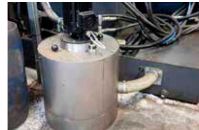
Dies ist unser hochwertiger externer Maschinenanschluss Typ CA, der für einige Anwendungen, wie z.B. bei der Bearbeitung von Aluminiumspänen, erforderlich ist.
